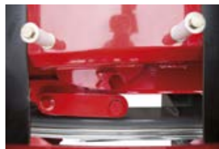
Механическая блокировка стола стабилизирует стол при сопряжении и транспортировке.
