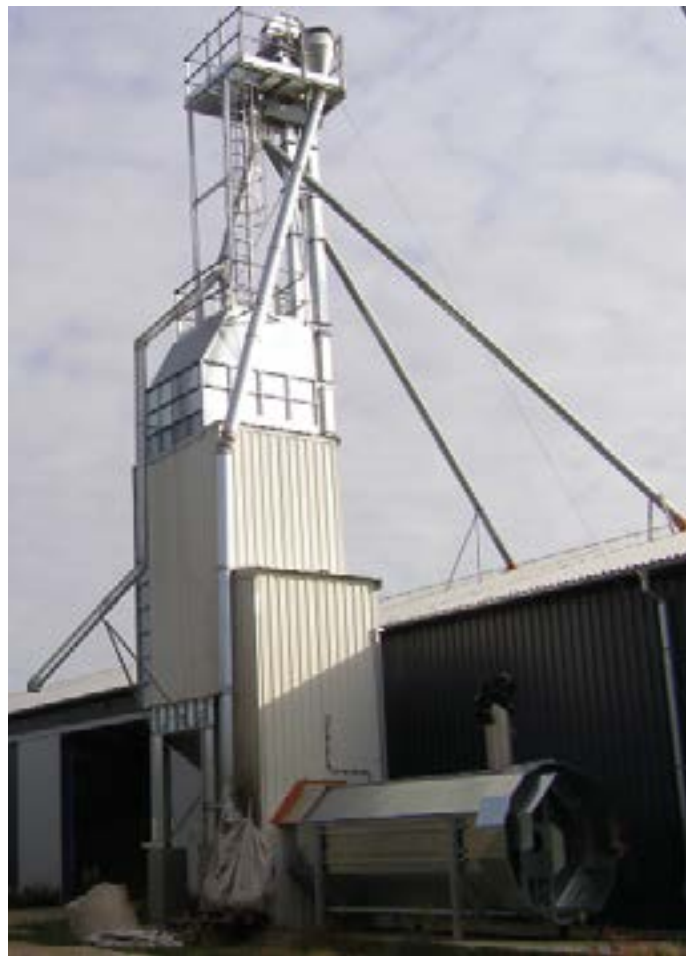
Сушилка с утеплением и печкой с теплообменником.
