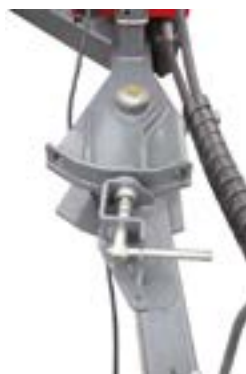
Дышло регулируется механически в трех положениях Транспортное–Рабочее
