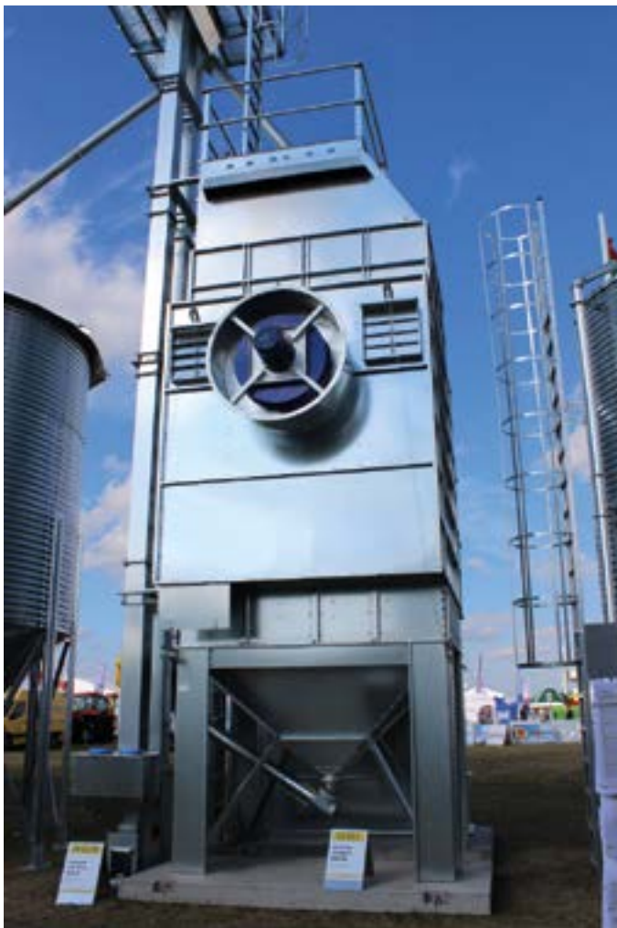
Сушилка с утеплением и печкой с теплообменником.
