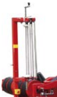
Механизм подачи пленки – для пленки 500 и 750 мм с автоматической регулировкой натяжения
